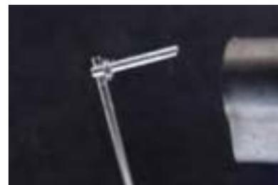
**Figura 8** - Rolo de solda de prata aplicado na haste menor e maçarico para realizar soldagem definitiva.
