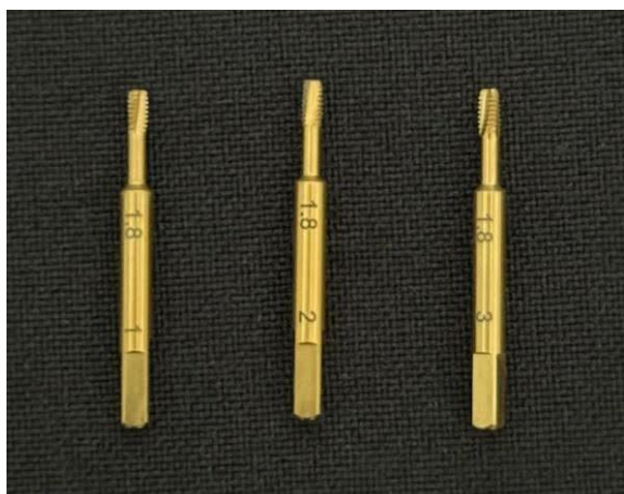
Figura 3 - Remoção de componentes com rosca fraturada 16 .
