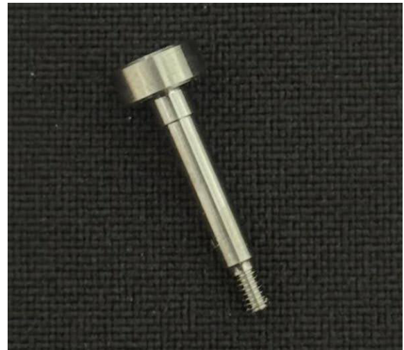
Figura 2 - Remoção de componentes fraturados com parafuso passante 16 .
