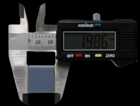
Fig. 2 “Fuente propia” Vernier digital midiendo el cubo post-curado
